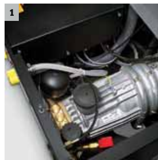
1 Wassergekühlter 4-poliger Elektromotor
